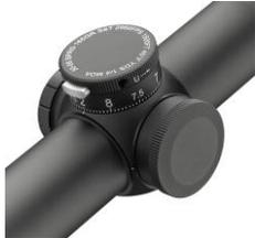
誤って回転させてしまってもゼロにならないようにダイヤルボックスがあります。ボタンを押すだけで必要に応じて動かせエレベーションダイヤルは、2回転目でボタンが沈んで 2回転目のターンに入ってる事が分かります。
